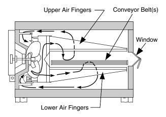
Figure 1-4. PS540-Series Oven Air Flow
